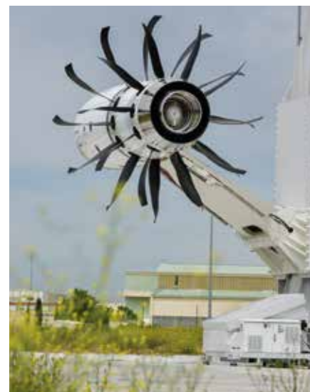
Système de propulsion CROR de Safran au banc d'Istres.
